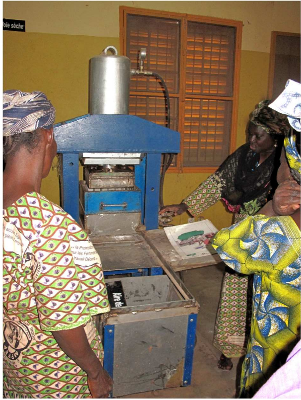
extractrice - voie sèche
