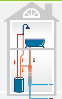
La chaleur des eaux utilisées préchauffe l'eau froide © Gaz Métro
